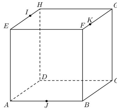
On peut maintenant appliquer les techniques vues précédemment pour déterminer la section d'un solide par un plan, c'est à dire l'intersection de ce plan avec les différentes faces du solide. Ces intersections sont des segments tracés sur les faces du solide. cf exemple pas à pas de la page suivante.
